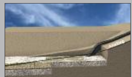
Dränmaterial verdichten und glätten
