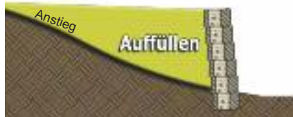
Standort mit Auffüllung
