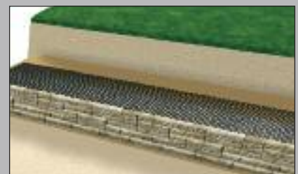
Einbau der nächsten Geogitterlage
