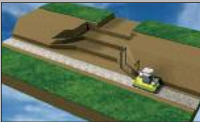
Hinterfüllen und Verdichten
