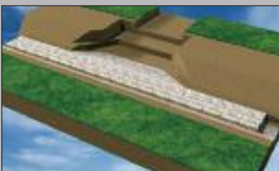
Dränagematerial verfüllen und Verdichten
