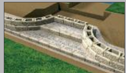
Stützmaueraufbau außerhalb der Treppe
