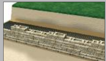
Verlegung der nächsten Reihe
